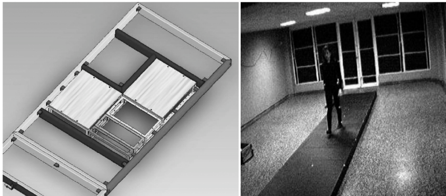
Figura 9. Pasarela para el desplazamiento del paciente. En la figura (a) se representa el diseño de la pasarela que permite el desplazamiento y ubicación una plataforma de fuerza de acuerdo a la longitud del paso del paciente. La Figura (b) presenta la pasarela desarrollada para el laboratorio de Marcha.
