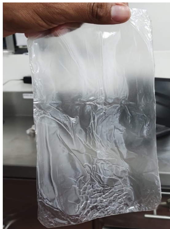
Figura 3. Membranas obtenidas con almidón de plátano extraído.
