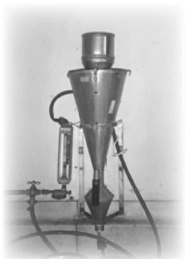
**Figura 1.** Levigador de Oostembrink utilizado para aislar los nematodos de muestras de suelo.
