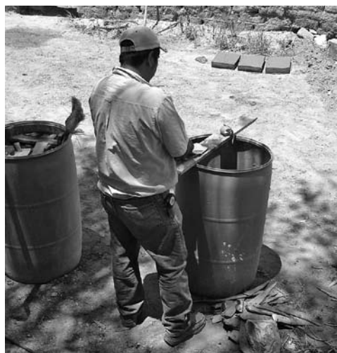
Figura 6: Extracción tradicional de la pulpa de sábila –Aloe vera– para elaborar adobes. Tula, Tamaulipas, México.
