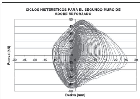
Figura 45: Algunos ciclos de histéresis centrados del segundo muro reforzado.
