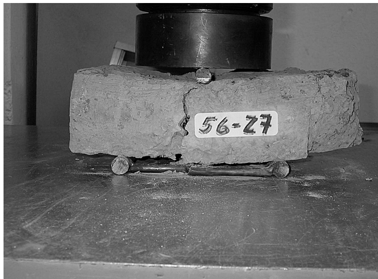
Figura 6: Caracterización mecánica, compresión sobre adobes. Fotografía: Juan Carlos Rivera
