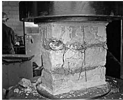
Figura 8: Caracterización mecánica en la ECI: compresión sobre muretes de adobe. Fotografía: Juan Carlos Rivera
