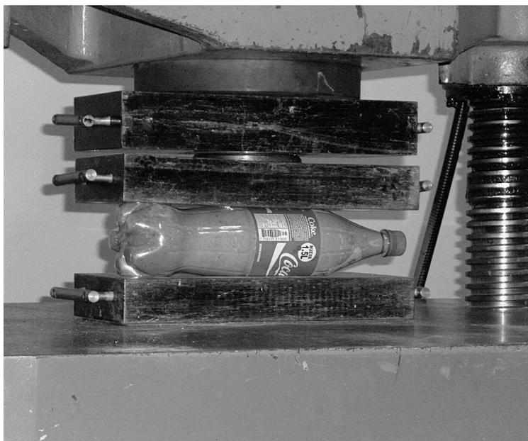
de menor tamaño (600 ml) presentaron una carga resistente superior y las botellas vacías soportaron una carga notablemente inferior a la que soportan las botellas con algún tipo de relleno.
