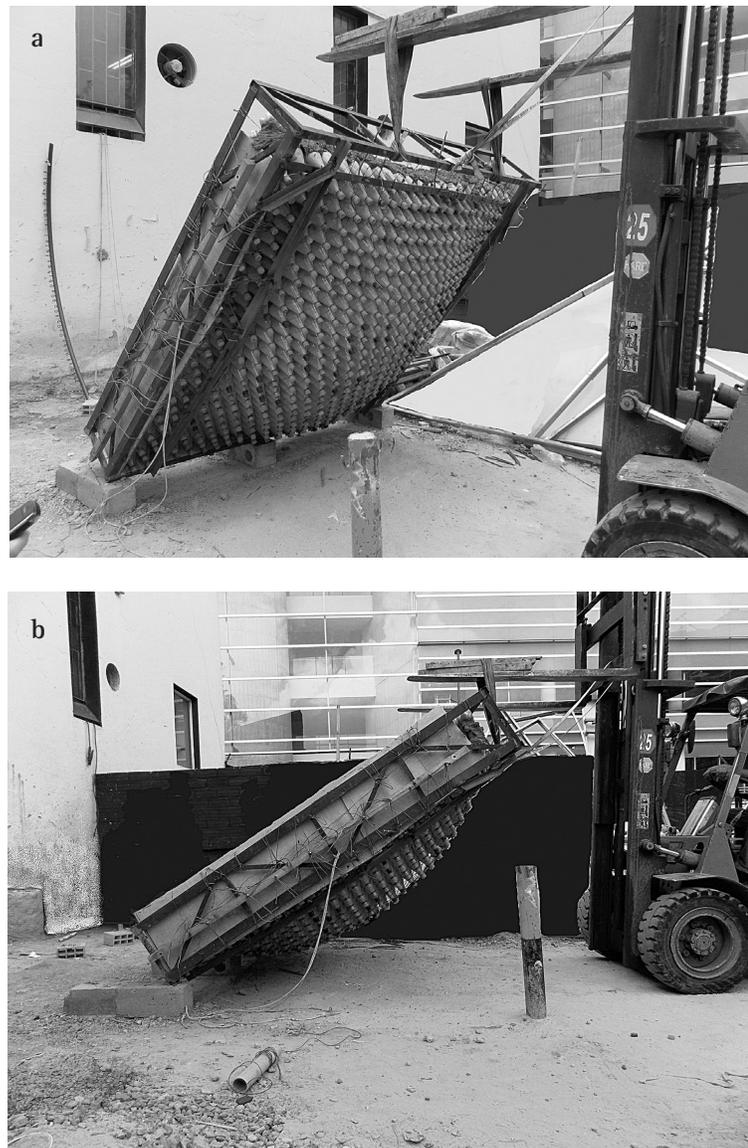
Figura 7: Ensayo preliminar de volteo en muros de botellas. a) Detalle del volteo con Montacargas. b) Estado del muro con una inclinación de 60 grados.
