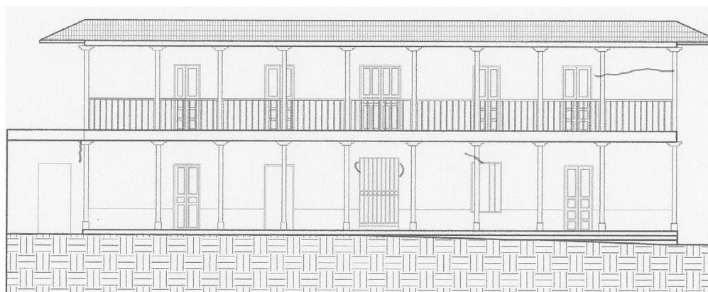
Figura 13: Fisuras en muros de fachada principal de la casa consistorial de Cogua Fuente: elaboración propia
