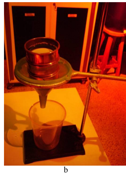
Figura 6. a. Esquema de montaje para tamizado en húmedo; b. Foto de montaje para tamizado en húmedo
