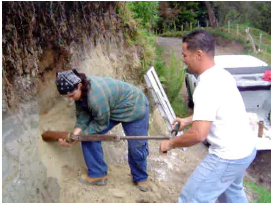
Figura 4. Toma de muestras para fotoluminiscencia utilizando el aparato percutor. Debido al alto grado de compactacion general de la muestra, es necesario la participacion de al menos dos personas en le proceso de extraccion.
