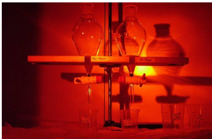
Figura 8. Montaje para separación con líquidos pesados. Los embudos separadores se colocan dentro de un armario para disminuir la entrada de luz y se dejan reposar al menos dos horas para asegurar una buena separación
