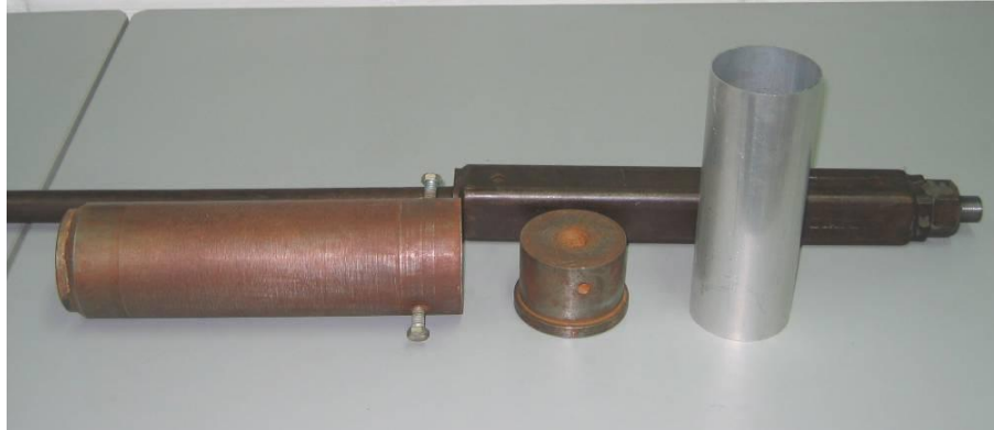
Figura 3. Equipo de extracción de muestras para fotoluminiscencia basado en un sistema de percusion tipo shelby.
