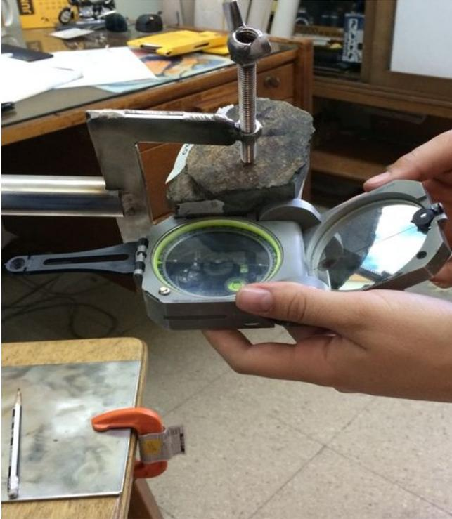
Figura 4. Orientador en acero inoxidable, permite la fácil orientación y rotación de la muestra en tres ejes.
