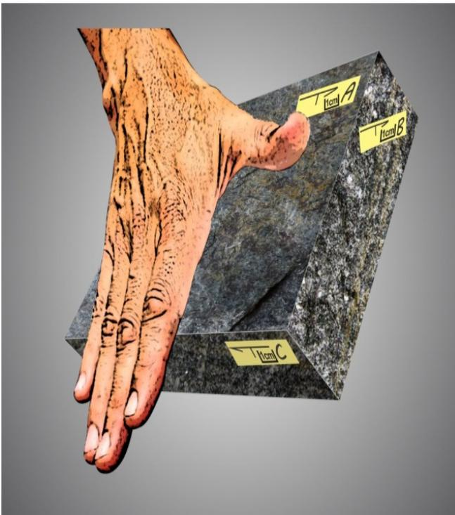
Figura 5. Ilustra la regla de la mano derecha. Observar la dirección del dedo pulgar que corresponde con el rumbo (sentido) del plano.
