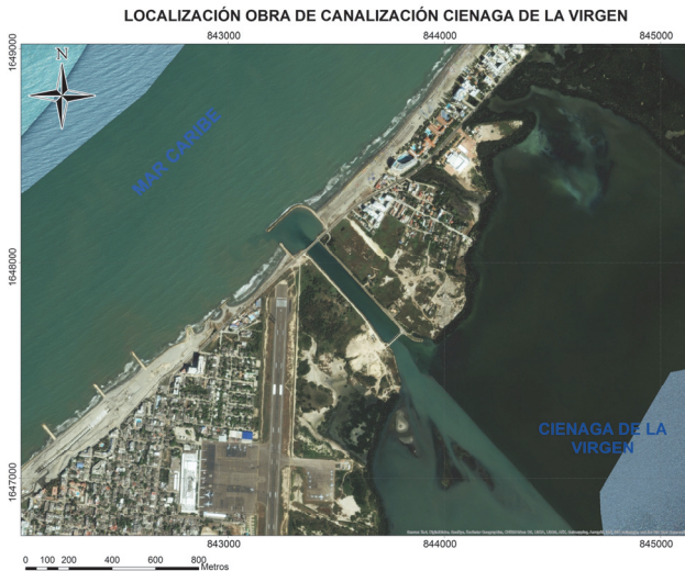
Figura 7. Canal de salida de agua de la Ciénaga de la Virgen con un Guía Corriente en la desembocadura atrapando los sedimentos. Fuente: Adaptado de ArcGis Mape Base 2015.
