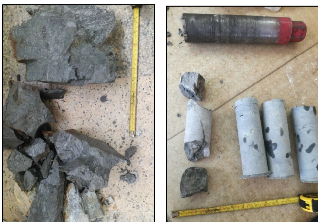
b) De un bloque de roca y broca de perforación tipo NX.
