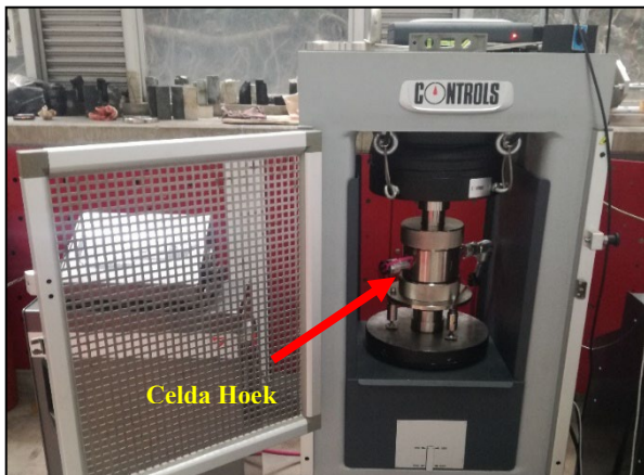
Figura 25. Cámara de compresión triaxial y celda Hoek. Fuente: Los Autores
