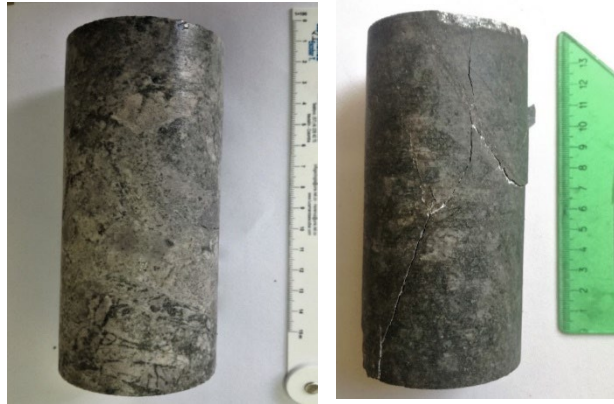
Figura 33. Núcleo de roca antes (íntegro) y después del ensayo de compresión triaxial.
