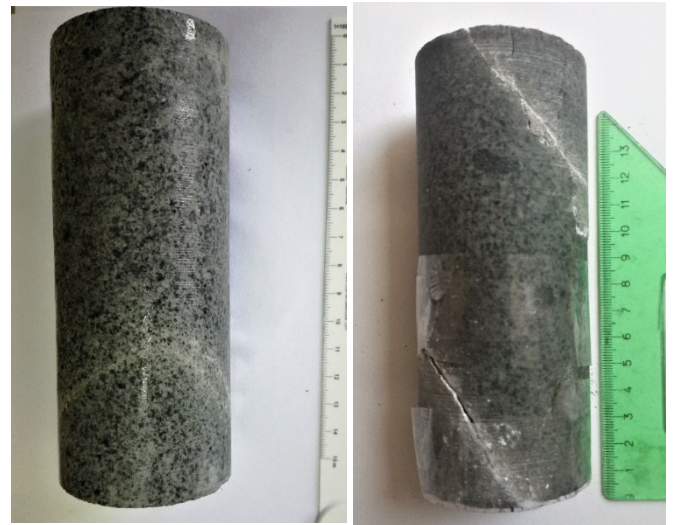
Figura 35. Núcleo de roca antes (íntegro) y después del ensayo de compresión triaxial.
