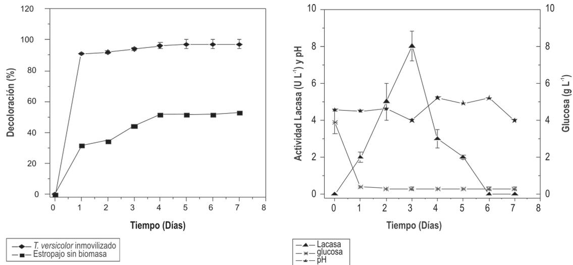
**Figura 3.** Curvas de remoción del NR5 en columna de burbujeo. Decoloración (%) para *T. versicolor* inmovilizado y el soporte libre de biomasa (izquierda). Consumo de glucosa ( $\text{g L}^{-1}$ ), actividad lacasa ( $\text{U L}^{-1}$ ) y pH (derecha). 7 días,  $30\text{ }^{\circ}\text{C}$ ,  $1000\text{ cm}^3\text{ min}^{-1}$  flujo de aire.
