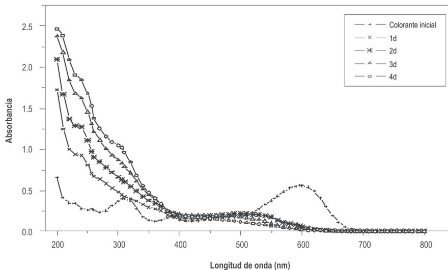
**Figura 5.** Espectro de absorción UV/VIS para el colorante NR5 durante las curvas de remoción en columna de burbujeo. 7 días, 27 °C, 1000 cm<sup>3</sup> min<sup>-1</sup> flujo de aire.
