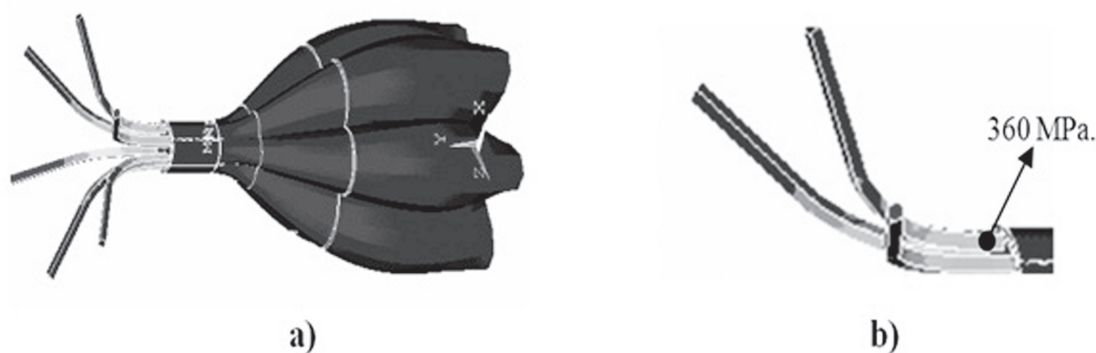
Figura 13. Representación gráfica tridimensional de la estructura y membrana. a) Pliegue de la válvula completa, b) esfuerzos producidos durante el pliegue.
