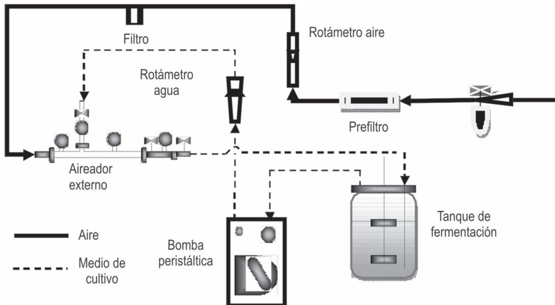
**Figura 1.** Configuración del sistema de fermentación con aireador externo.
