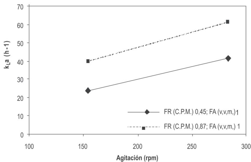
Figura 7. Variación del  $k_{LA}$  con la agitación cuando el flujo de aire es de 1 vvm.
