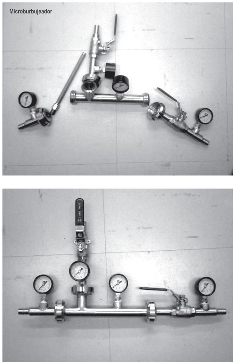
**Figura 2.** Aireador externo, despiece y ensamble.
