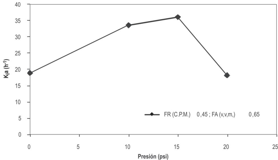
**Figura 8.** Variación del  $k_{La}$  con cambios de presión en el aireador externo para un flujo de recirculación de 0,45 CPM y un flujo de aire de 0,65 vvm.
