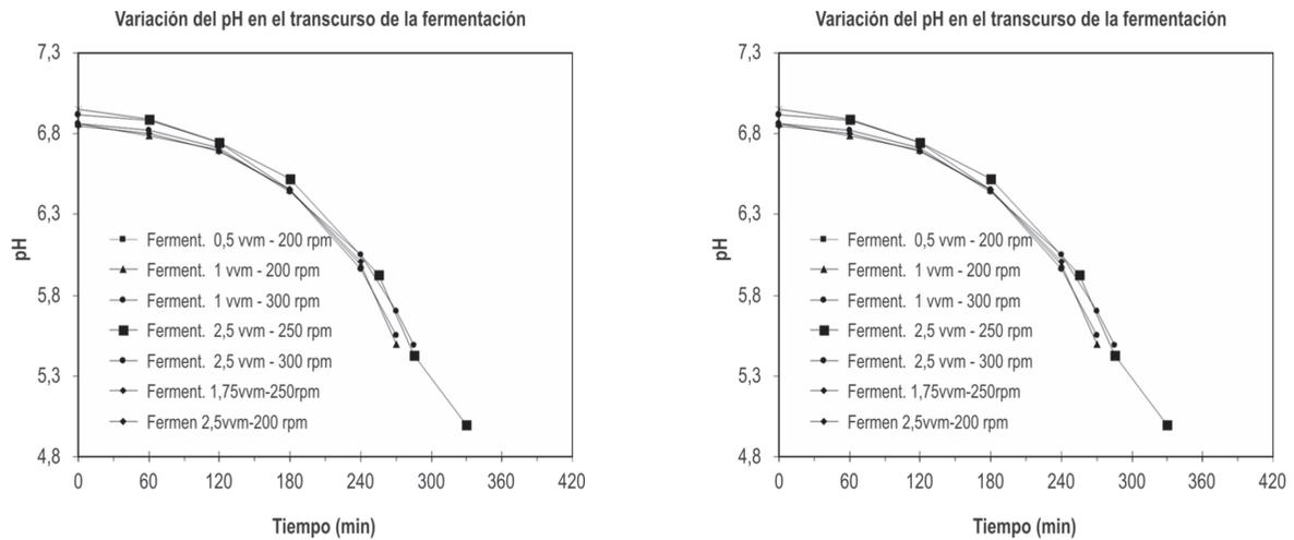
Figura 4. Cinéticas de crecimiento y variación de pH en cultivos con *Lactococcus lactis* IBUN 34.1 para diferentes niveles de oxigenación en el fermentador convencional.
