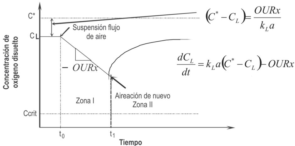
**Figura 3.** Curva característica para la determinación del valor de  $k_{La}$  por el método dinámico para cada condición de fermentación evaluada.
