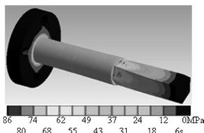
Figure 22. AD2 axis (von Mises stress).
