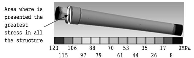
Figure 24. AD4 axis (von Mises stress).
