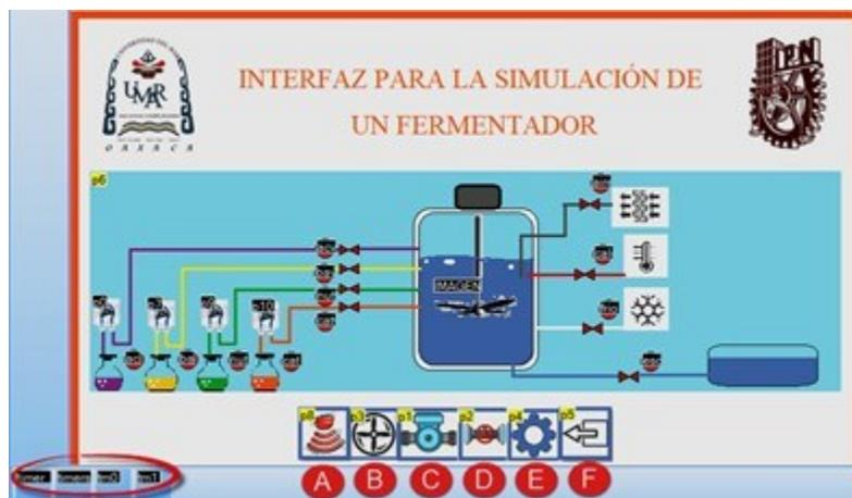
**Figura 4. Pantalla principal.** Diseño general de la interfaz **Fermenta V1.0**, en la parte inferior se encuentra la barra de opciones, en la parte central el esquema de un fermentador, en la parte izquierda las bombas dosificadoras y en extremo derecho el sistema de control de temperatura, suministro de aire y recuperación de producto. (Fuente: Elaboración propia).
