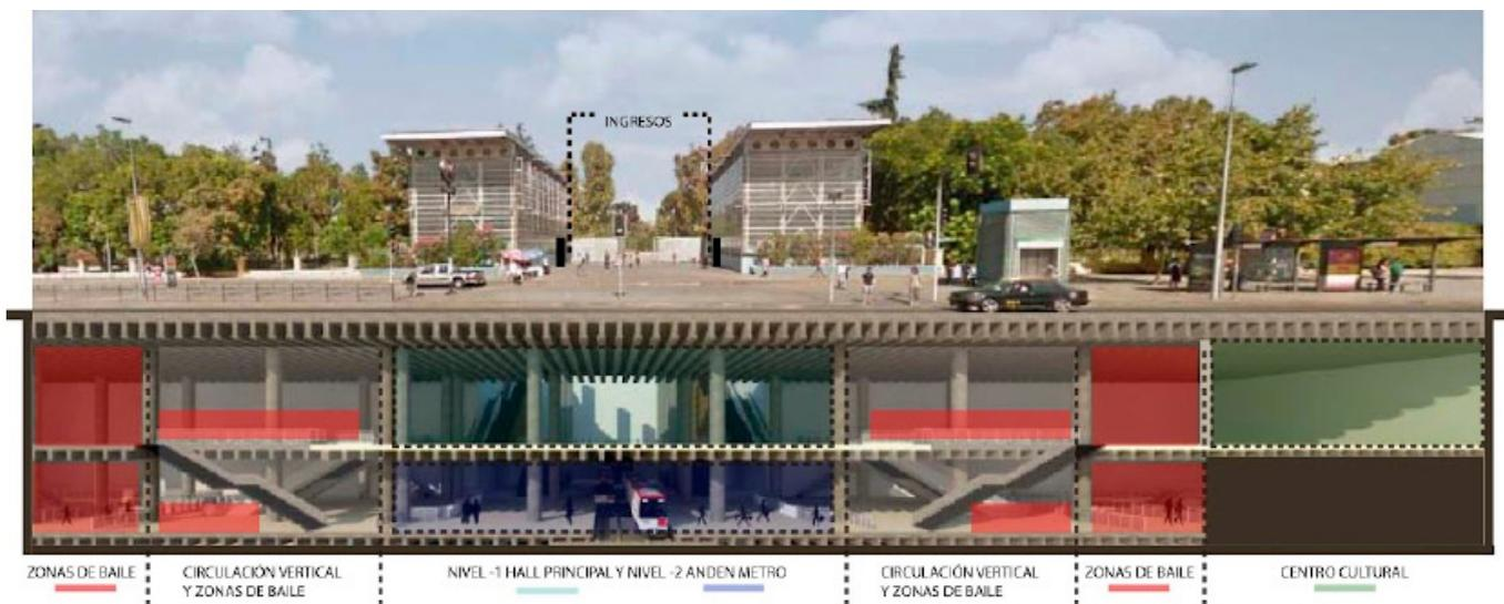
Figura 1. Corte esquemático Estación de metro Quinta Normal.
