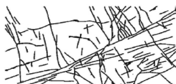
FIGURA 2. Ejemplo de trazas de fracturas. Las trazas se miden manualmente y se calculan los parámetros indicados. A = área de la imagen; D = densidad de las microfracturas. Tomado de Samaniego et al. , (2003).
