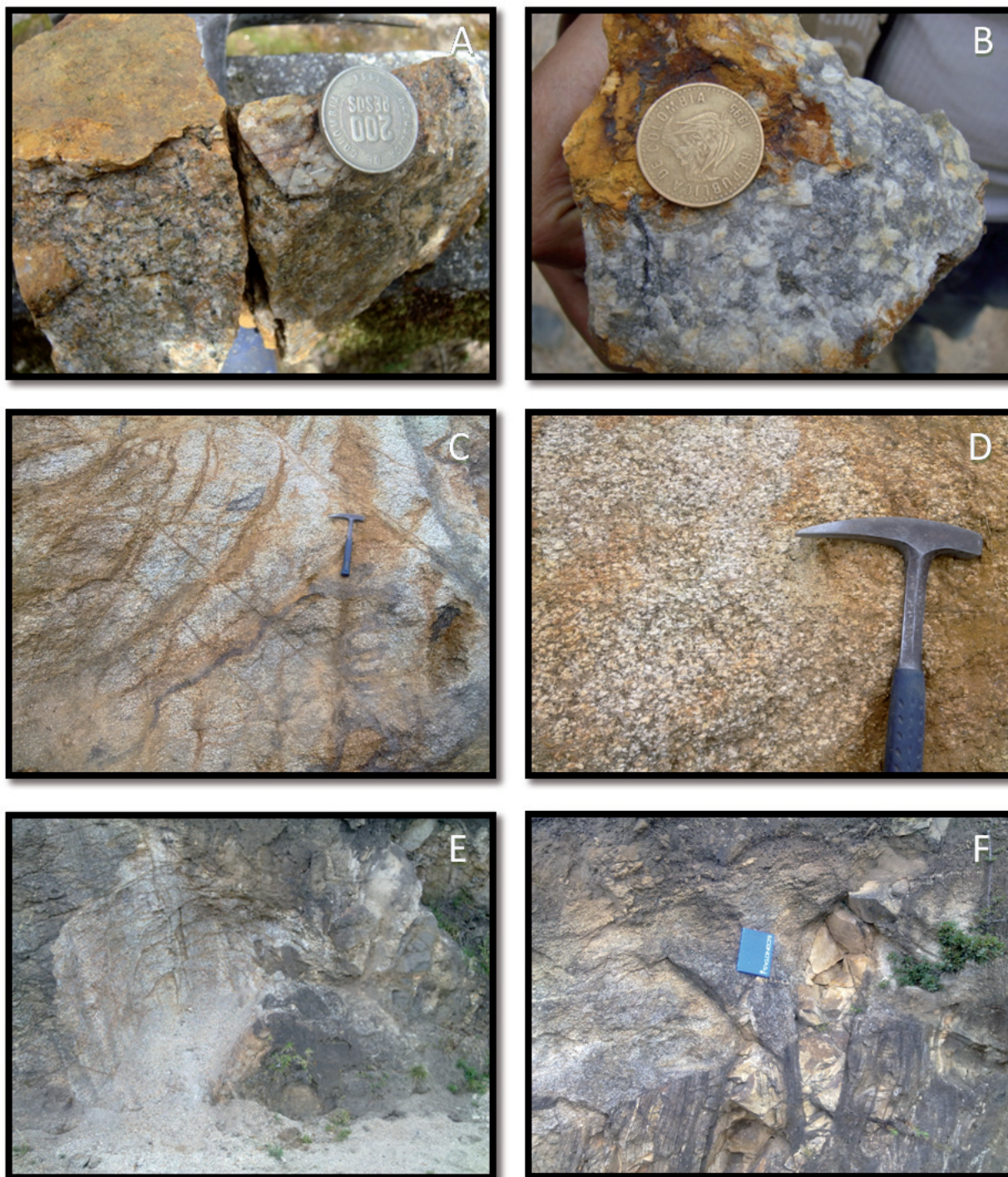
FIGURA 3. A. Muestra TPD-46, correspondiente a un bloque rodado de un pórfido riódacítico del sector de la quebrada La Plata; B. Muestra TPD-15-9, correspondiente a un material andesito silicificado (parte de un núcleo silíceo) aflorante en el sector de San Celestino. C. Muestra TPD-72, correspondiente a un cuerpo granodiorítico-cuarzomonzodiorítico, de textura fanerítica, ligeramente porfirítica, aflorante por la Vía Vetas-El Mesetón, datado en el presente estudio mediante el método U-Pb en circones ( 10.9 \pm 0.2 \text{ Ma} ); D. Aspecto de la misma muestra TPD-72 (ampliada), datada en el presente estudio; E y F. Aspecto de las rocas granodiorítico-cuarzomonzodiorítico (Muestra TPD-72 y TPD-73, respectivamente), hacia el contacto (neto) con las rocas del Neis de Bucaramanga.
