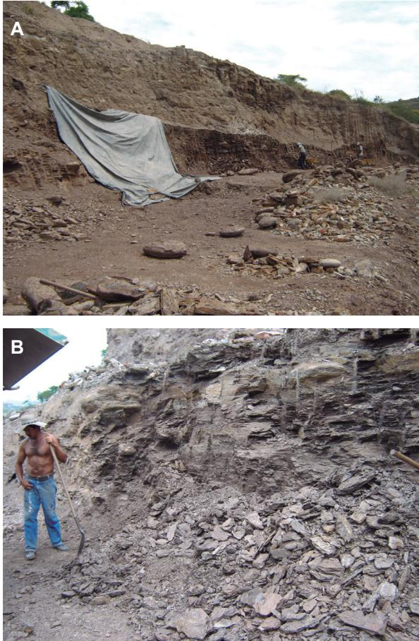
**FIGURA 5.** Sitio de explotación. **A:** vista general, se observa la posición subhorizontal de los estratos. **B:** vista de detalle; en la parte superior derecha las concreciones de caliza, debajo de ellas niveles con mineralización de sales de potasio.
