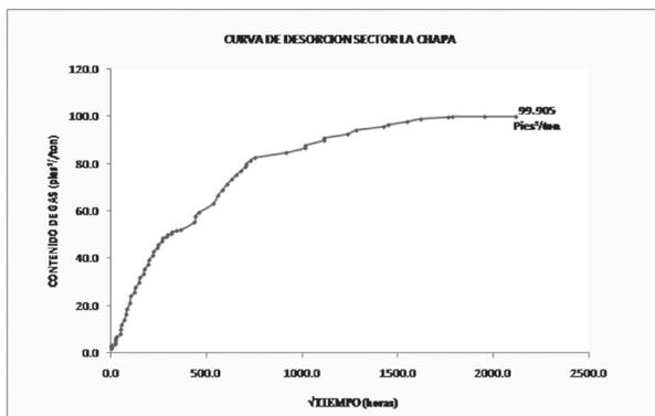
**FIGURA 6.** Curva de desorción en la muestra N.1 de pozo del Municipio de Tasco. El contenido acumulado en  $\text{pie}^3/\text{ton}$  se grafica contra la raíz cuadrada del tiempo en horas (Mojica, 2010).
