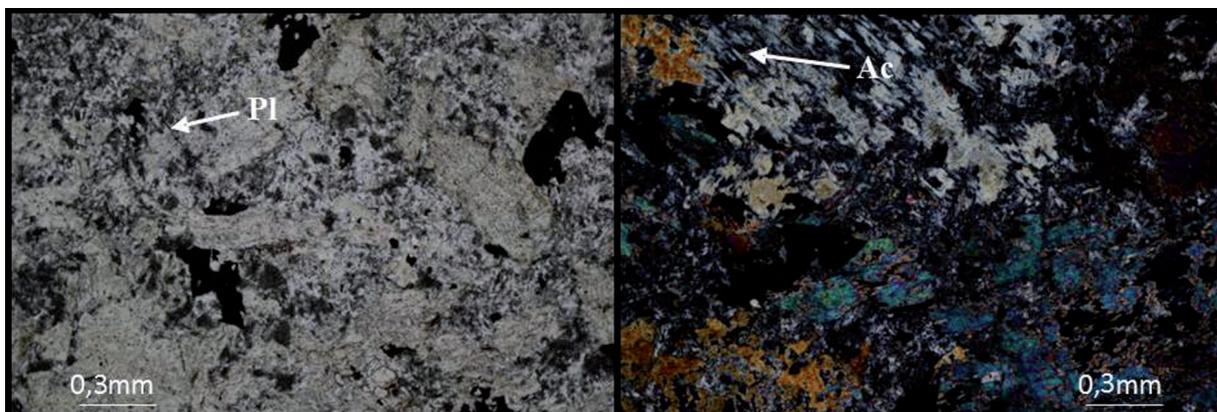
FIGURA 4. Aspecto microscópico del Metagabro del Ariari con textura holocristalina donde la plagioclasa (Pl) está completamente alterada y el anfíbol desarrolla cristales fibrosos de actinolita (Ac).
