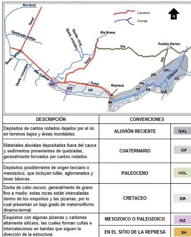
FIGURA 4. Mapa geológico a lo largo del río Calima, en proximidad al emplazamiento del embalse Calima (Tomado de CVC, 1954).
