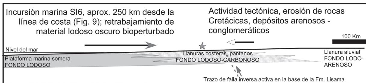
**FIGURA 10.** Perfil esquemático ilustrando la procedencia marina-marginal del material lodoso que suprayace la superficie SI6 y del material terrígeno grueso que se genera por la actividad estructural cercana a área fuente.
