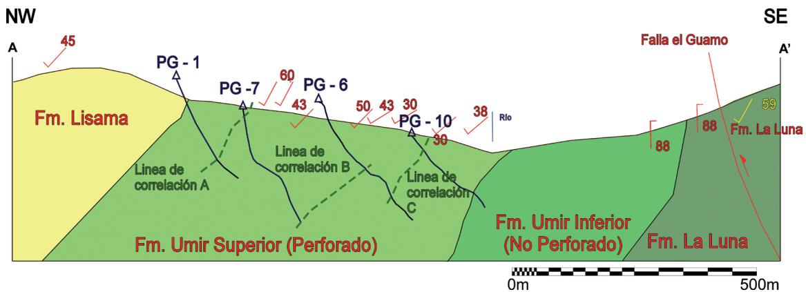
**FIGURA 2.** Corte geológico (escala horizontal igual a la vertical) donde se proyectan los pozos PG-1, PG-7, PG-6 y PG-10. Un espesor de 548 m se calculó para el segmento superior de la Formación Umir y 276 m para el segmento de inferior, el cual no fue perforado.
