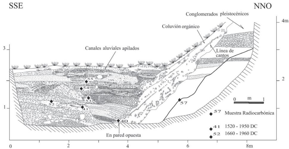
**FIGURA 9.** Levantamiento geológico de la pared oeste de la trinchera Yaritagua (–T8- en la FIGURA 2). Se identifican todos los puntos de muestreo para datación radiocarbónica, aunque sólo se reportan sólo la edad de dos de ellas. En texto, ver explicación.
