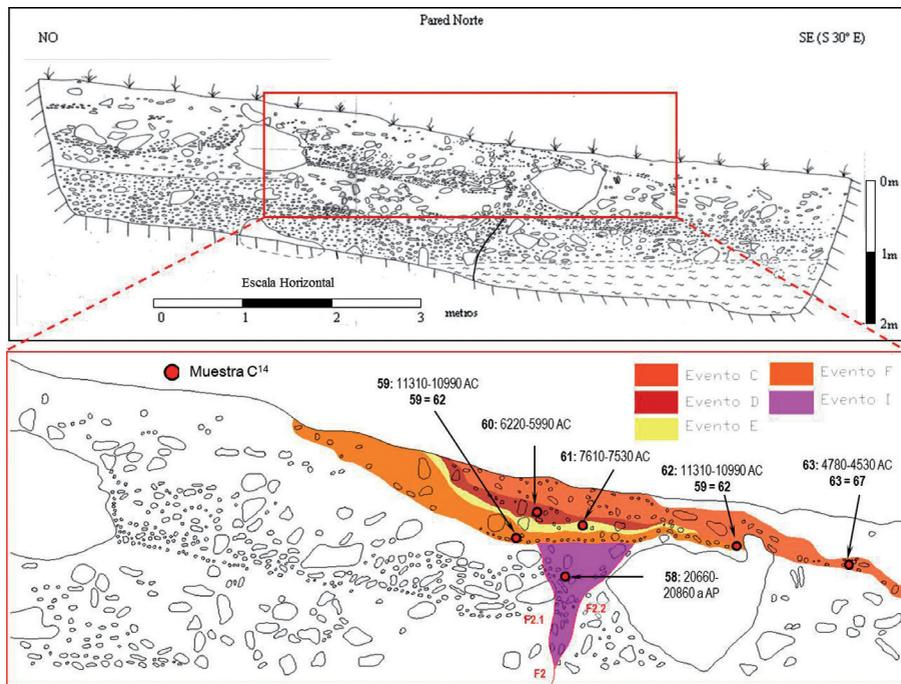
**FIGURA 14.** Levantamiento geológico la pared este de la trinchera Quigua (–T9- en la FIGURA 2; dibujo del levantamiento por Reinaldo Ollarves). Se reportan todos los puntos de muestreo para datación radiocarbónica, así como sus edades calendario calibradas con 2 sigma de desviación. La ocurrencia de los sismos está aquí evidenciada por la formación de cuñas coluviales derivadas de la erosión del escarpe de falla y en una ocasión, por una grieta abierta rellena subyacente (ver Audemard, 2005).
