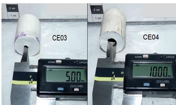
FIGURA 7. Plugs sintéticos de concreto
