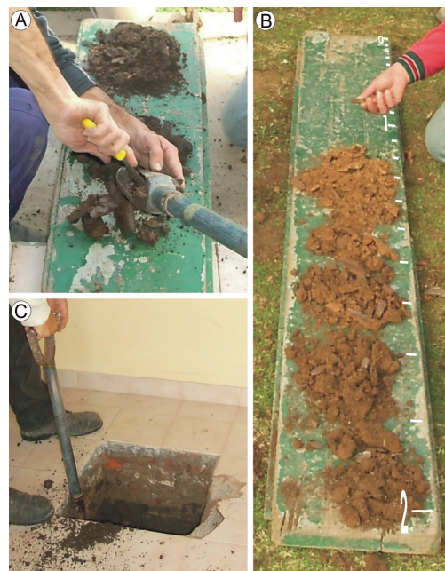
FIGURA 5. A. Obtención de los materiales extraídos por la cuchara del barreno manual. B. Perfil litológico del subsuelo reconstruido en superficie con muestras obtenidas a distintas profundidades. C. Ejemplo de corte en un piso de cerámicos, dentro de una habitación, para acceder al subsuelo.
