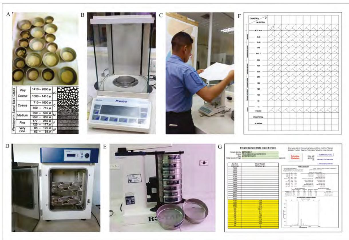
**Figura 3.** Equipos empleados para la realización de la granulometría. **A.** Muestras dispuestas para los análisis. **B.** y **C.** Equipo digital para pesar los sedimentos. **D.** Secado de las muestras. **E.** Columna de tamices y agitador. **F.** Formato donde se anotan los datos en el tamizado. **G.** Vista del programa GRADISTAT, a la izquierda donde se agregan los pesos de cada tamiz y a la derecha, presentación de resultados.
