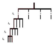
**Figura 7.** Rutas de descomposición por *wavelets* en patrón de "árbol". Se dan descomposiciones para cada nivel jerárquico  $(J_1, J_2, J_3, J_4...)$  determinadas por un número de sub-DEMs =  $2^{2n}$  (4, 16, 64...). La línea roja punteada muestra las rutas de descomposición-recomposición 1112 y 1114 referidas en el texto para nuestro caso piloto.
