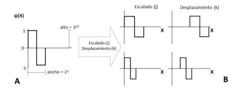
**Figura 6.** Escalado y desplazamiento de la *wavelet Haar.* **A.** Definición gráfica de la  $\psi(x)$  para una *wavelet Haar.* **B.** Escalado (j) por cambio en altura (amplitud), ancho (frecuencia) y desplazamiento (k) en x de la *wavelet Haar.*
