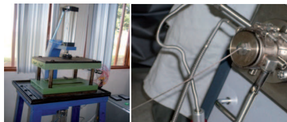
Figura 1. Elaboración de Termoformados (Moldeo por compresión) y películas flexibles (Extrusión).
