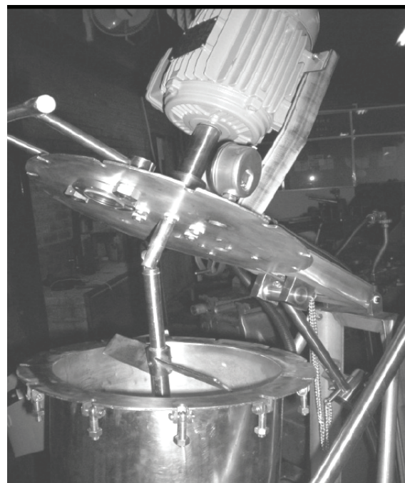
Figura 7. Detalle del posicionamiento de las aspas y cierre del equipo.
