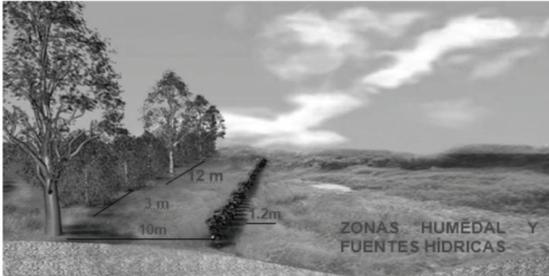
**Figura 3.** Implementación de trinchos con barreras vivas.
