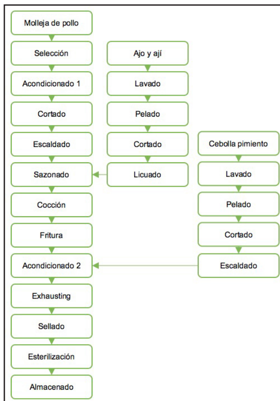
Figura 1. Diagrama de flujo del proceso.
