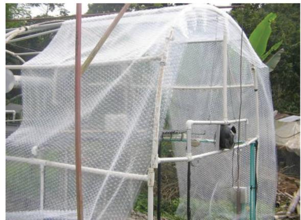
**Figura 4.** Cubierta plástica aislada con doble capa en secador solar de guadua asistido por gas o electricidad
