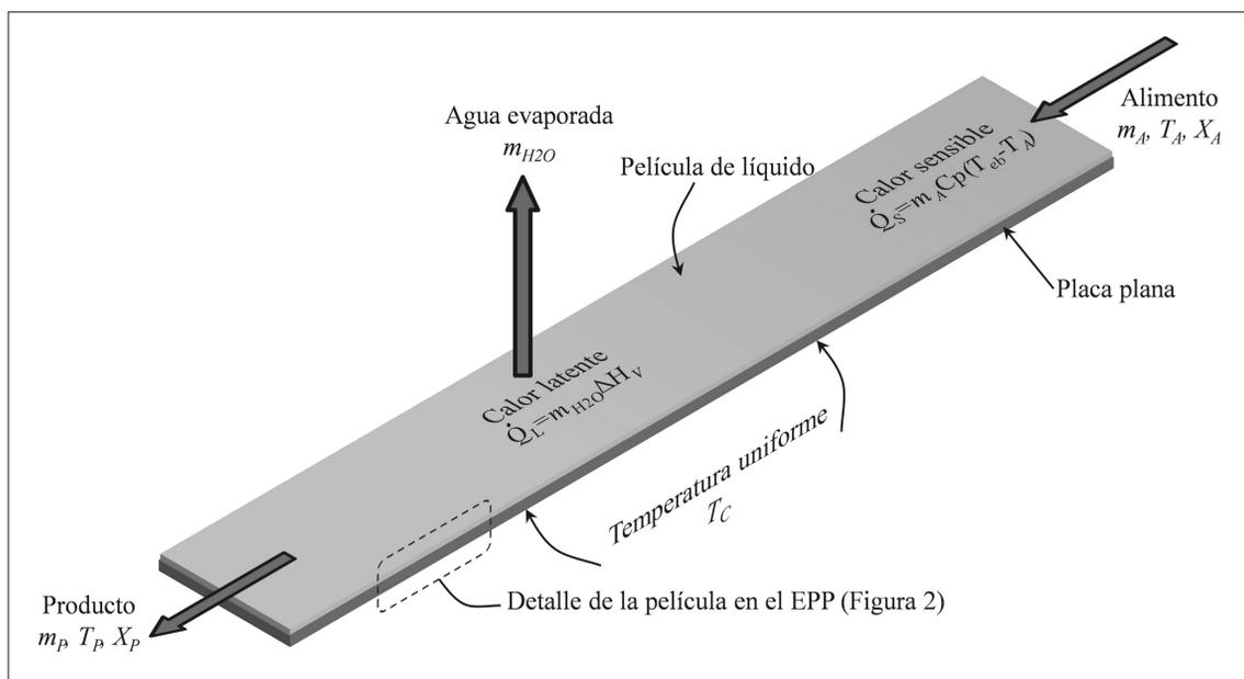
Figura 1. Evaporador de placa plana operando en película
