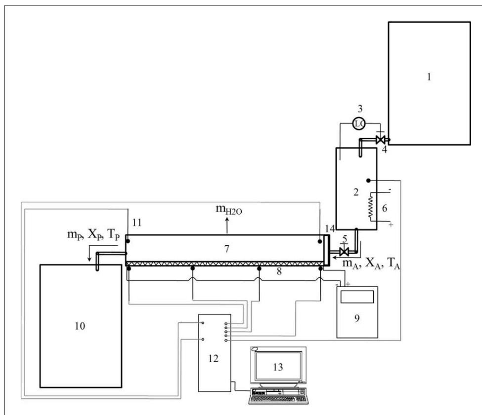
**Figura 3.** Diagrama esquemático del evaporador en película delgada a escala piloto: (1) tanque de almacenamiento, (2) tanque de abastecimiento, (3) control de nivel, (4) válvula solenoide, (5) válvula tipo compuerta, (6) resistencia eléctrica, (7) superficie de calentamiento, (8) resistencia eléctrica plana, (9) contador de corriente eléctrica, (10) tanque recolector, (11) termopar tipo K, (12) Data logger, (13) computador, (14) distribuidor.
