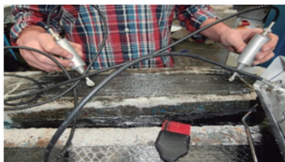
Fig. 9. Medición ultrasónicos método indirecto Fuente: elaboración propia.
