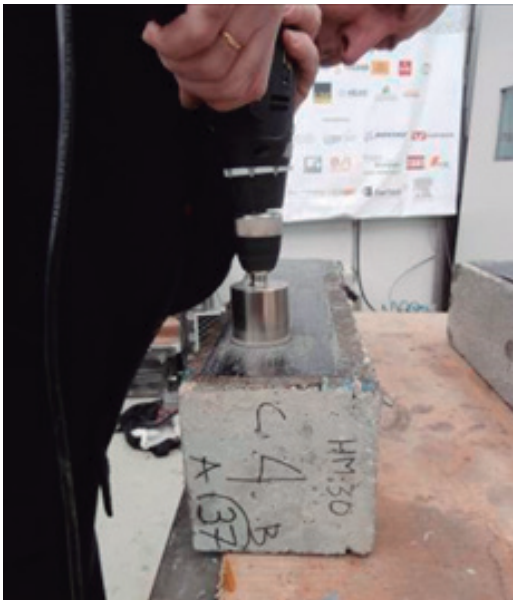
Fig. 4. Corte circular sobre FRP Fuente: elaboración propia.
