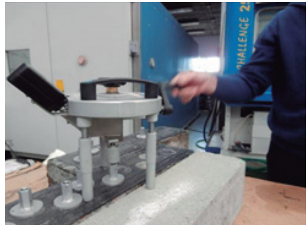
Fig. 7. Ejecución ensayo Pull-Off sobre la probeta Fuente: elaboración propia.
