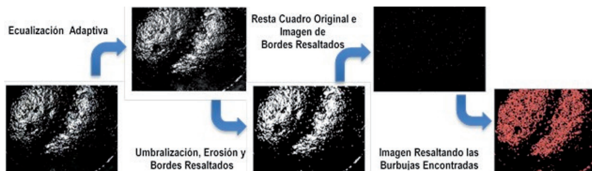
Figura 7. Procesamiento de la imagen de la superficie de la espuma cerca de la ER_{m\acute{a}x} . Fuente: Elaboración propia.
