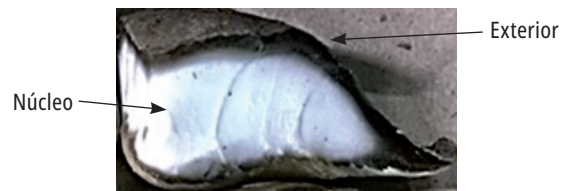
Figura 1. Muestra obtenida luego de efectuar un corte transversal a un fondo de taza de caucho natural. Fuente: Elaboración propia.
