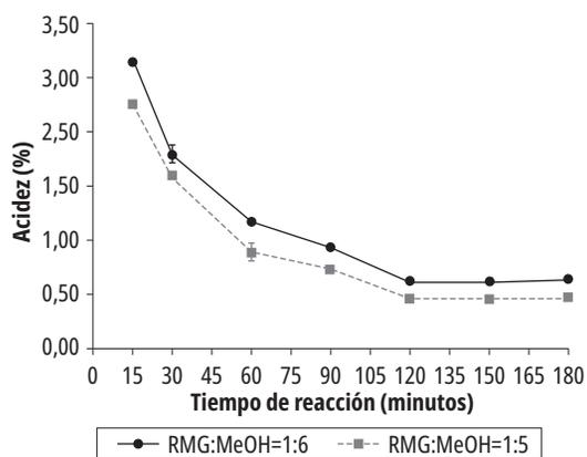
**Figura 1.** Efecto del tiempo de reacción sobre la acidez durante la esterificación de las grasas extraídas de la borra de café a 60°C con agitación de 100 rpm y concentración de catalizador ( $H_2SO_4$ ) del 0,7%. Fuente: Elaboración propia.
