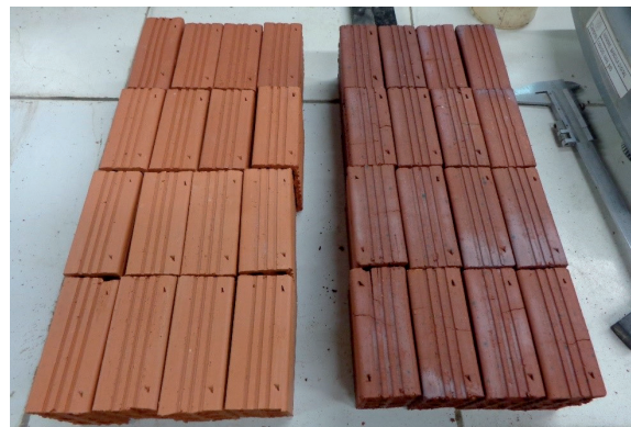
Figura 1. Ladrillos prototipo fabricados. A la izquierda , ladrillos sin adición de escoria. A la derecha , ladrillos con adición de escoria. Fuente: Elaboración propia.
