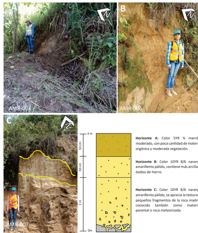
Figura 4. Extracción de muestras, a: perfil de suelo compuesto por materia orgánica, b: perfil compuesto por suelo residual del Batolito de Pueblo Bello, y c: perfil de meteorización
