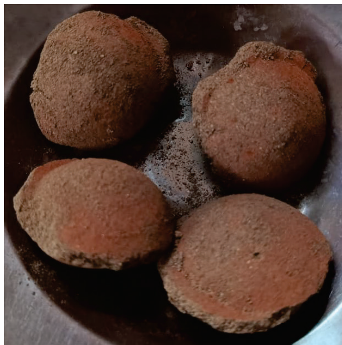
Figura 6. Briquetas sinterizadas a 500 °C
