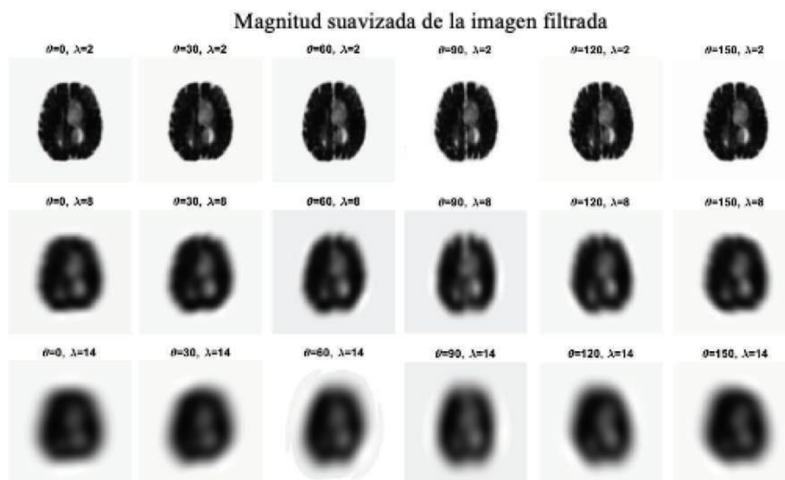
Figura 9. Magnitud suavizada de los coeficientes de Gabor resultantes luego de procesar la imagen de la figura 4a
