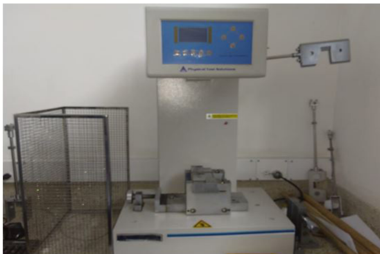
Figura 2. Máquina ITC-XJU-22 para prueba de impacto.
