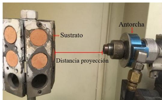
**Figura 1.** Montaje para la aplicación de los recubrimientos. Cámara de proyección ARESTE I UdeA.
