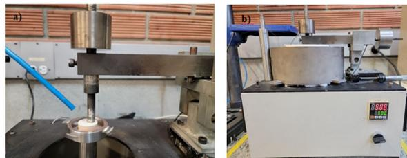
**Figura 3.** a) Montaje para los ensayos a temperatura ambiente b) Montaje para los ensayos a 500 °C.
