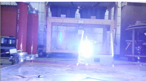
Figura 10. Presencia de arco eléctrico en el condensador asimétrico 1 en DC.
