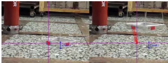
Figura 12. Simulación para obtener la aceleración y velocidad del condensador asimétrico.
