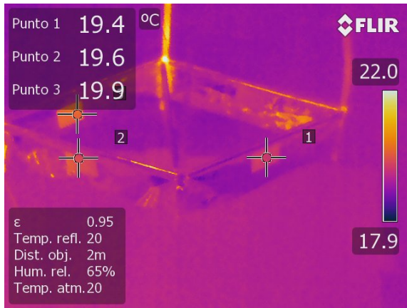
Figura 31. Distribución térmica del condensador asimétrico 2 (tensión aplicada en AC).
