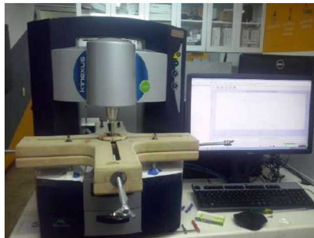
Figura 5. Integración entre el reómetro y el dispositivo magnético.
