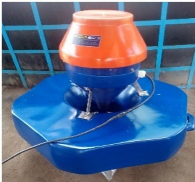
**Figura 4.** Sistema de aireación Splash empleado en (SB).
