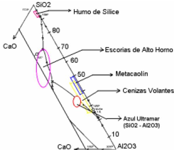
**Figura 1.** Diagrama de fase CaO – SiO<sub>2</sub> – Al<sub>2</sub>O<sub>3</sub>. Localización de materiales puzolánicos. Elaboración de los autores.
